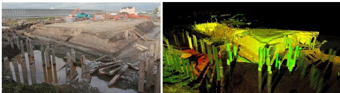
Рис. 3. Лазерное сканирование раскопок крепости Ниеншанц XVII в. Охтинский мыс. Санкт-Петербург [5]
