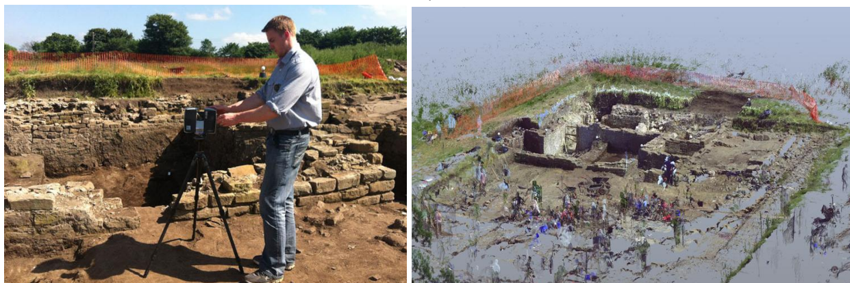
Рис. 4. Лазерное сканирование раскопок римских бань [4]
